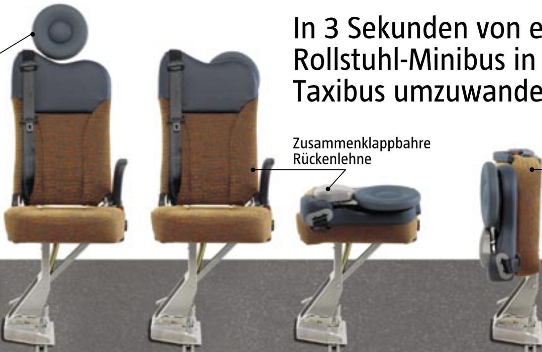
Das Flex-I-Trans-System® entspricht den M1 Normen und ISO 10452 Anforderungen, crashtested mit 50 Km/Std und einer Abbremsung von 20G.
